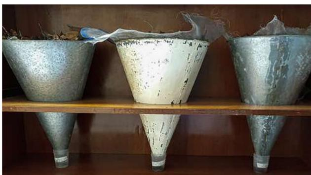
Figura 4. Método embudo de Berlesse-Tullgren la obtención de los microartrópodos edáficos. Fotografía: Valdez, L.
