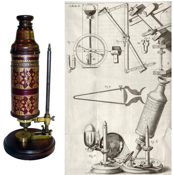
Figura 4. Foto actual y aguafuerte incluido en *Micrographia*, donde se representa el microscopio compuesto diseñado por Robert Hooke y manufacturado por Chistopher White durante ese periodo. Modificado de Hooke (1665: Schema 1).
